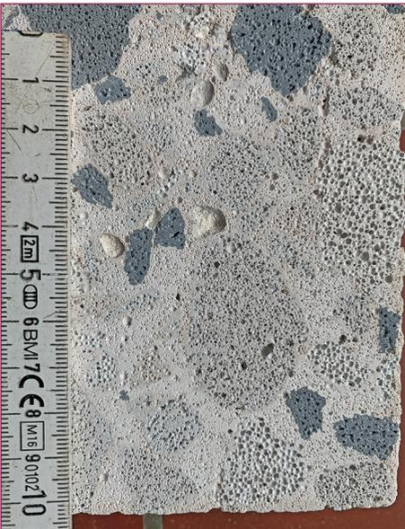
Bild 3: *Schaumstein* aus groben Porenbeton-Granulaten; Recycling-Bauprodukt im ersten Recycling-Zyklus
