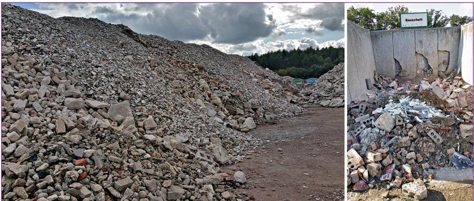
Bild 1: Haufwerke von Bauschuttabfällen aus dem Abbruch und der Anlieferung bei der Entsorgungsanlage
