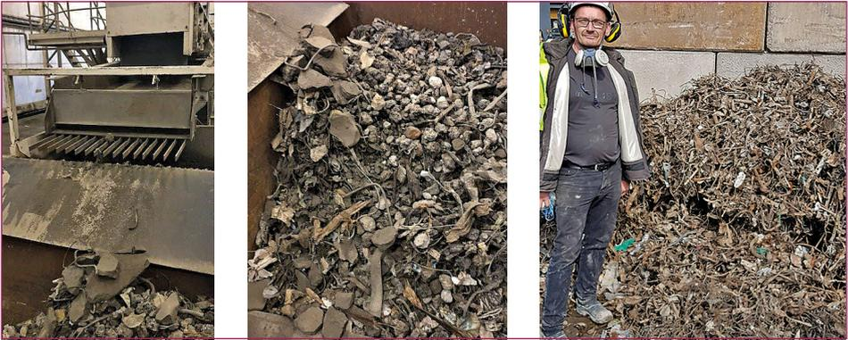
Bild 6: Links: Industrieller Einsatz: MVA-Rostaschenaufbereitung AFATEK Kopenhagen/DK. Mitte: Langteilkonzentrat. Rechts: Das Langteilkonzentrat nach einer manuellen Nachsortierung der Langteilmfraktion besteht weitestgehend aus Edelstahl.
