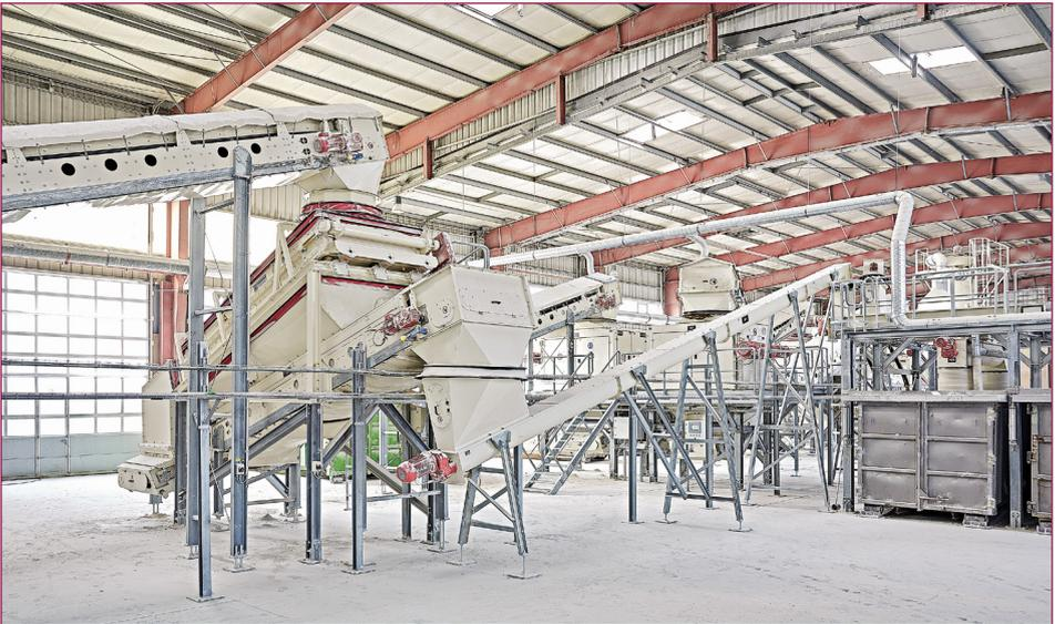
Bild 2: Aufbereitungsbereich mit Zerkleinerungs- und Klassierungstechnik
