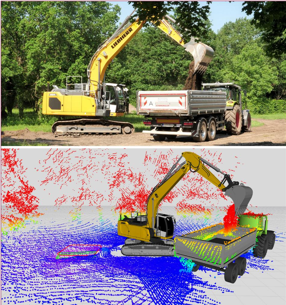
Bild 6: Beladevorgang des autonomen Transportfahrzeugs durch den autonomen Raupenbagger (oben). Interne Sicht der Systeme auf das Szenario (unten).
