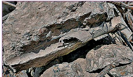
Bild 4: Bruchkante entlang einer Schalungshülse
