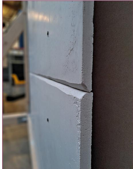
Bild 5: Gipsgebundene Bauplatten aus feinem rezyklierten Porenbeton-Brechsand
