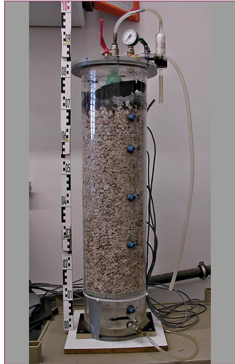
Bild 1: Testreaktor des Ansatzes *Methanox* auf Basis von Porenbeton- und Kalksandsteingranulaten
